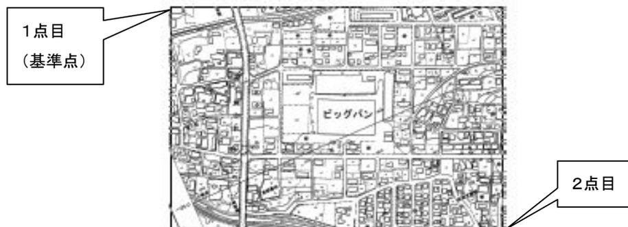
3.補正先ラスターの基準点を指示します。矩形状に範囲指定します。
