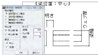
梁伏図・ピン接合
